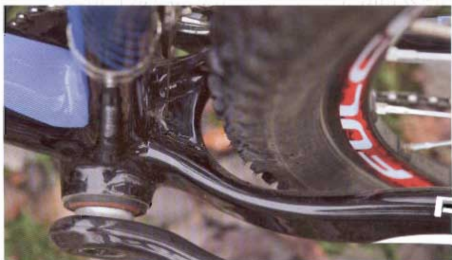
Mohutná středová partie dává rámu dostatečnou pevnost. Tu podtrhují klíky Sram X.0 o váze 788 gramů.
