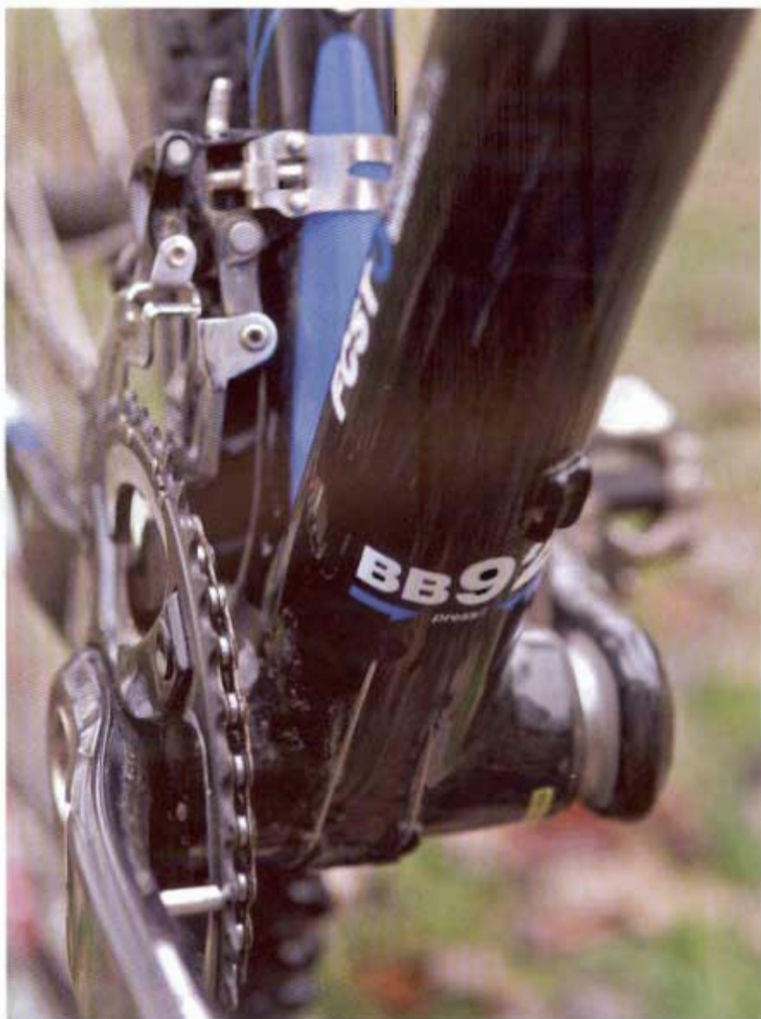
Os BB92 má rozšířenou středovou spojku rámu s integrovanými ložisky dovnitř. Díky tomu jsou ložiska lépe chráněna.
